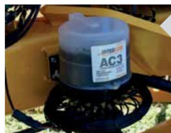
**SYSTÈME DE GRAISSAGE AUTOMATIQUE EN OPTION**
