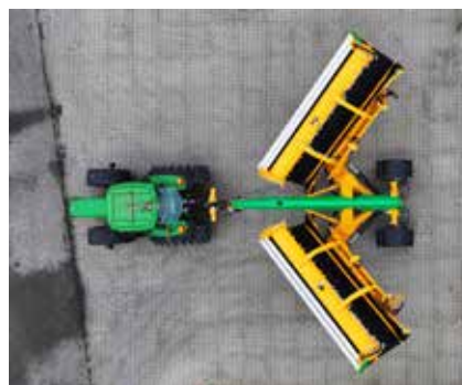
Maskine 100% udfoldet, center-skår position
