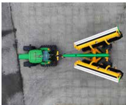
Maskine 100% udfoldet, side-skår position
