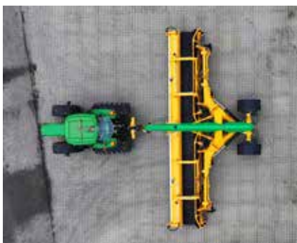
Maskine 100% udfoldet, side-skår position
