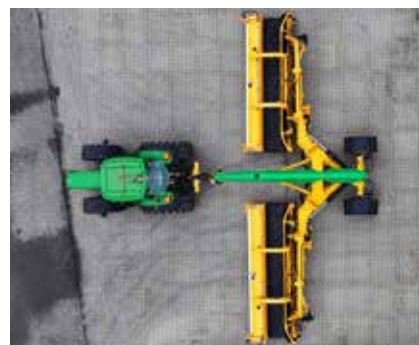
Maskine 100% udfoldet, center-skår position
