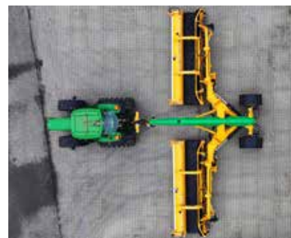
Machine dépliée à 25% en position andain central
